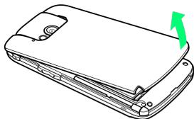
・ディスプレイを下向きの状態にして、本体のくぼみから電池カバーを持ち上げて取り外します。
