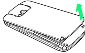
・ディスプレイを下向きの状態にして、本体のくぼみから電池カバーを持ち上げて取り外します。
