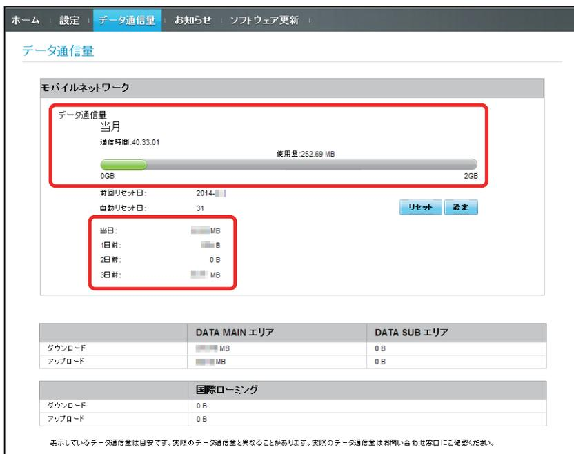
ご利用開始もしくはリセットしてから現在までのデータ通信量が表示されます。また、当日から最大3日前までのデータ通信量も表示されます。
