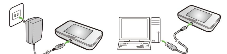
AC アダプタの microUSB プラグを本機の外部接続端子に、AC アダプタの電源プラグを家庭用 AC コンセントに差し込みます。
