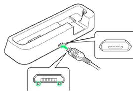
・microUSBプラグを誤った向きに差し込むと、卓上ホルダーの接続端子が破損することがあります。microUSBプラグの形状と向きをよく確かめて、突起 (○部分) を下にして差し込んでください。
