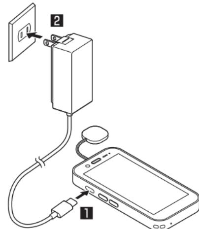
**3** 充電が完了したら、ACアダプタの電源プラグをコンセントから抜き、ACアダプタのUSB Type-Cプラグを本機から取り外す
