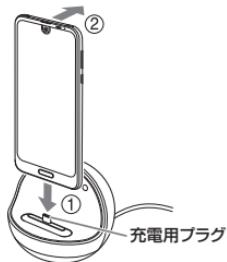
**③ 充電が完了したら、ロボクルから本機を取り外し、ACアダプタのUSB Type-Cプラグを取り外す**
