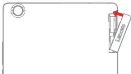
**ステップ 6.** 本体の背面側を上にして、カードスロット・カバーを矢印の方向に閉じます。
