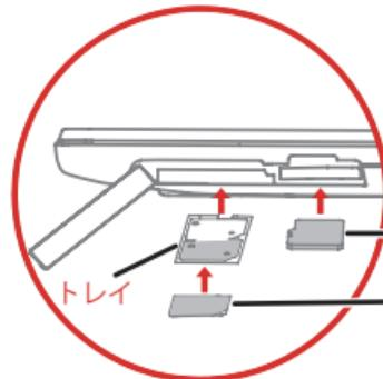
ステップ2. トレイを引き出し、USIM カードの金属端子面を上に向け、トレイの「1」と印字されたガイドにあわせて置いた後、元の位置に挿入します。SD カードの金属端子面を上に向け、本機の SD カードスロットに挿入します。
