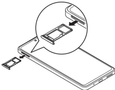
**3** USIMカードのIC（金属）面を下にして、USIMカード／SDカードトレイに取り付ける
