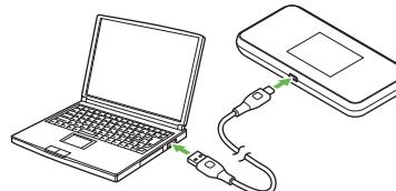
USB ケーブルの USB Type-C プラグを本機の外部接続端子に、USB プラグをパソコンの USB ポートに接続します。
