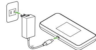
AC アダプタ（別売）の USB Type-C プラグを本機の外部接続端子に、電源プラグを家庭用 AC コンセントに差し込みます。
