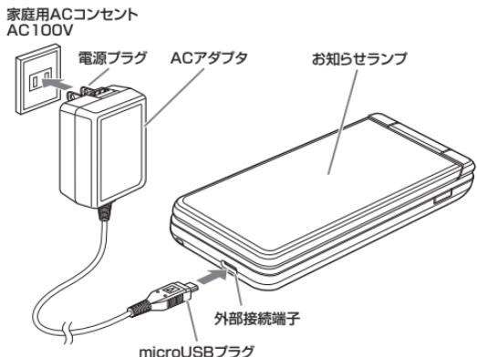
**① ACアダプタのmicroUSBプラグを、本機の外部接続端子に差し込む**
