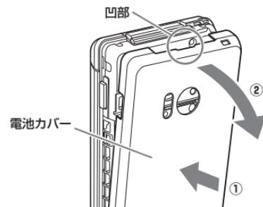
●電池カバーの中央部を押さえながら(①)、凹部に指先をかけて、矢印の方向(②)にひいて取り外してください。
