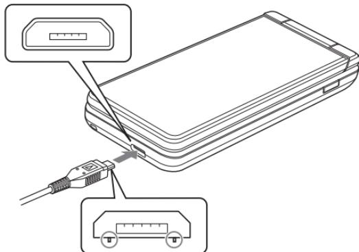
**③ 本機の外部接続端子から、ACアダプタのmicroUSBプラグを取り外し、ACアダプタのプラグを家庭用ACコンセントから抜き、プラグを元の状態に戻す**
