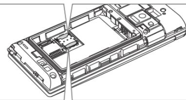
切り欠きの位置に注意し、USIMカードを図のようにUSIMカードスロットカバーに取り付けます。
