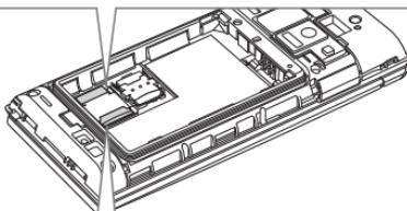
差し込む向きに注意して、SDカードを図のようにSDカードスロットカバーに取り付けます。
