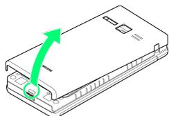
・外部接続端子部のくぼみに指先をかけて、電池カバーを矢印の方向へゆっくりと持ち上げるようにして取り外してください。
