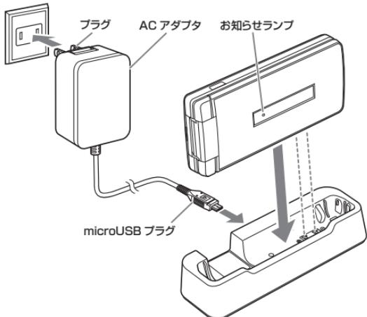
**① ACアダプタのmicroUSBプラグを、卓上ホルダーの接続端子に差し込む**
