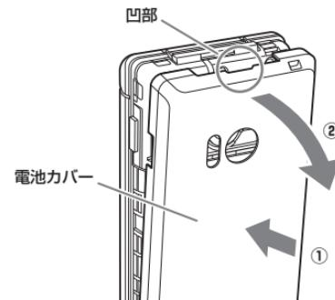
●電池カバーの中央部を押さえながら(①)、凹部に指先をかけて、矢印の方向(②)にひいて取り外してください。
