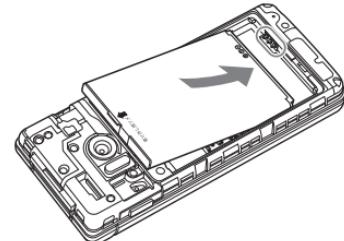
●電池パックの先を合わせて、矢印の方向に取り付けてください。
