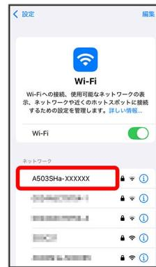
・本機の「SSID」が表示されていない場合は、本機の電源キーを押してスリープモードを解除してください。
