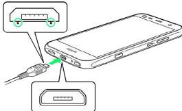
・microUSBプラグを誤った向きに差し込むと、本機の外部接続端子が破損することがあります。microUSBプラグの形状と向きをよく確かめて、突起（○部分）を下にして差し込んでください。
