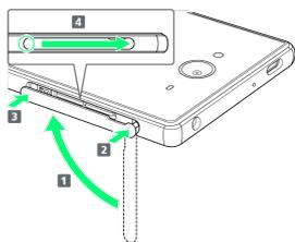
・カード挿入口キャップを ❶ の方向へ上げ、付根部を収納し ( ❷ )、本機とカード挿入口キャップにすき間が生じないように合わせ、矢印の方向に押しつけて閉じてください ( ❸ )。
