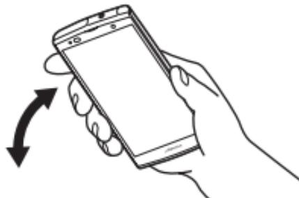
**3** 乾いた布などに本機を軽く押し当て、送話口・受話口・スピーカー・イヤホン端子・TV/FMトランスミッタ用アンテナ・キーなどの隙間に入った水分をふき取る
