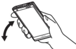
**3** 乾いた布などに本機を軽く押し当て、送話口・受話口・スピーカー・イヤホン端子・ワンセグ／FMトランスミッタ用アンテナ・キーなどの隙間にに入った水分をふき取る
